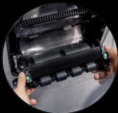
Полный доступ к режущему механизму позволяет просто и быстро его очистить
